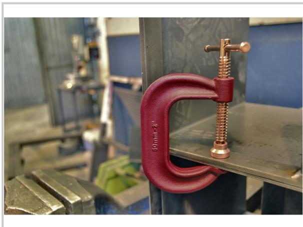
Presse à vis en forme de C spéciale soudure grande puissance de serrage
