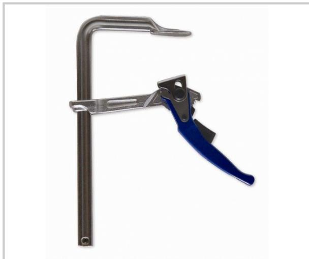
Presse rapide en acier forgé d'une seule pièce grande puissance de serrage modèle rapide à cliquet cranté poignée ergonomique libération rapide de la détente recommandée pour les travaux de soudure puissance de serrage : - 30620 : 3500N - 30625 : 4000N - 30630 : 4000N .
