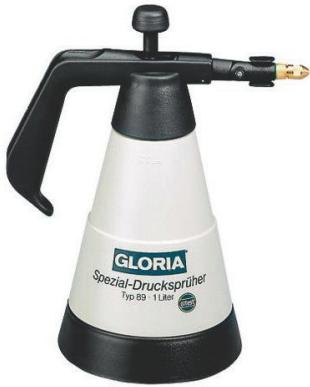
Pour l'application de liquides chimiques et à base d'huile, ainsi que pour l'entretien des machines et véhicules réservoir en plastique robuste joints en FKM résistants aux huiles et solvants buse en laiton réglable avec tête orientable pompe de précision en plastique anneau de base pour une stabilité accrue soupape de sécurité intégrée capacité de remplissage 1 L capacité totale 1,45 L pression de service maximale 3 bar.
