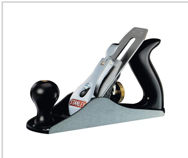
Rabot métallique professionnel entièrement réglable : molette de réglage de la profondeur du fer, levier de gauchissement, vis d'avance du chariot permettant d'ouvrir ou de réduire la lumière.
