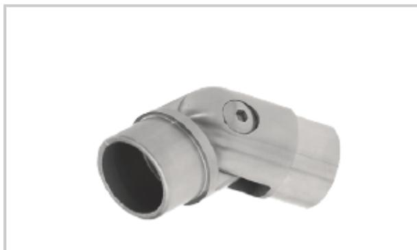
Le raccord de main courante orientable permet de raccorder deux mains courantes rondes entre elles afin de réaliser un angle compris entre 85° et 180°, vers le haut et le bas ou de droite à gauche.
