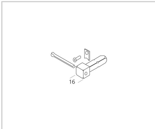
Pièce de raccordement pour moteur tubulaire
