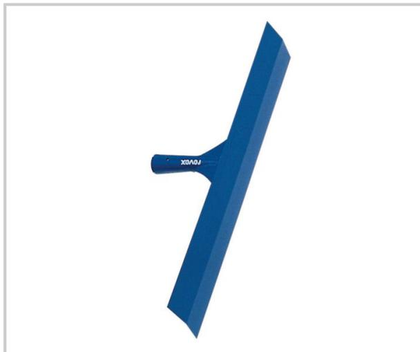
Le racloir macadam associé à un manche adapté, permet de tirer, racler et niveler les goudrons, les bétons ou les gravillons longueur : 12,50 cm largeur : 50 cm hauteur : 10 cm poids : 1,2 Kg.
