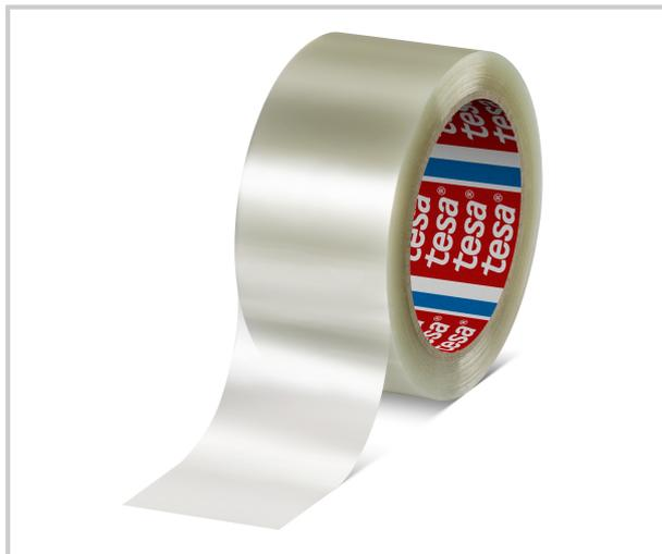
Ruban adhésif d emballage en polyester recyclé support PET solide, résistant à la déchirure et à la perforation masse adhésive acrylique polyvalente à base d'eau convient aux applications d emballage de charges légères à modérées (30 kg maximum), fermeture des cartons convient aux dévidoirs manuels et automatiques épaisseur : 56 µm.
