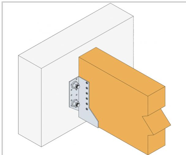
Applications : solives, pannes, poutres lisses et montants de bardage, butées de chevrons, renforcement d'assemblage existants...
