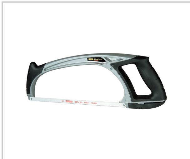
Scie à métaux spéciale usage intensif. Tension jusqu'à 120 kg. Repose main avant. Revêtement anti-dérapant. Monture aluminium très résistante. Verrouillage et déverrouillage par levier autobloquant. Réglage et mémorisation de la tension par molette crantée. 2 positions de lame = 90° et 45°. Capacité de coupe: 127 mm.
