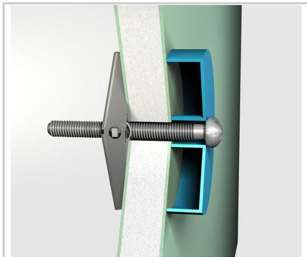
Ancrage automatique par expansion cheville : diamètre 18mm et rayon de 30mm longue tige filetée du segment basculant permet l'utilisation dans des matériaux d'épaisseurs diverses, y compris des grandes épaisseurs répartition uniforme de la portance auto expansion sous l'effet du ressort, convient aux applications au plafond applications : étagères légères, poignées et crochets, tableaux, lampadaires, éclairage, miroirs.
