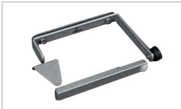
Sélecteur de vantail assure le respect de l'ordre prioritaire d'un bloc porte à deux vantaux matériel exigé sur les portes coupe-feu à double vantail réversible droite et gauche équipé d'une roulette caoutchouc poids maxi de la porte : 100 kg.
