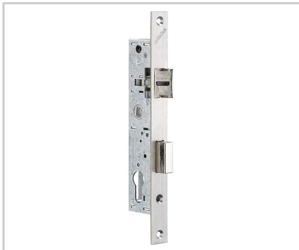
Pour profils étroits acier et alu pêne 1/2 tour confort et pêne dormant réversible fouillot carré Zamak : 8 mm coffre acier : 180 m x 15 mm tétière plate acier brossée : 240 mm x 2,5mm fonctionnement avec cylindre profil européen standard (pour largeur 21 et 28 mm livré avec gâche et fonctionnement avec cylindre à panneton raccourci). coffre et pièces internes traitées anti-corrosion, rappel du 1/2 tour à la clé, sauf sur le coffre de 21 et 28 mm garantie 5 ans.
