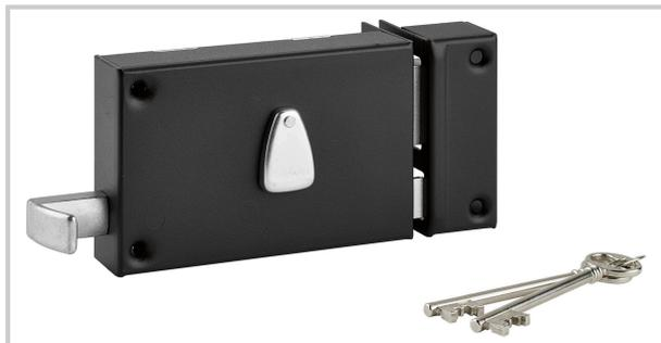
Coffre et gâche acier cambré époxy noir granitépêne et demi-tour acier canon alliage longueur 45 mm écanisme à 6 gorges 2 tours avec tirage ou à fouillote ntrée de clé acier à tirage : rappel du demi-tour par la clé livrée avec 2 clés nickelées (20 variures) garantie 10 ans.
