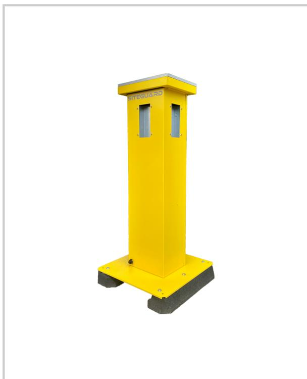
La tour SiteGuard est une solution pour une protection complète d'un chantier sans alimentation électrique grâce à une batterie intégrée et un panneau solaire. 100% autonome, elle offre une couverture à 360 degrés à une distance maximale de 30m et une vérification photo des alarmes en 9 secondes. En cas de détection d'une intrusion, StreetSiren Jeweller active le son de 113 dB et des lumières clignotantes LED pendant 3 minutes. La tour est facile à installer et à transporter.
