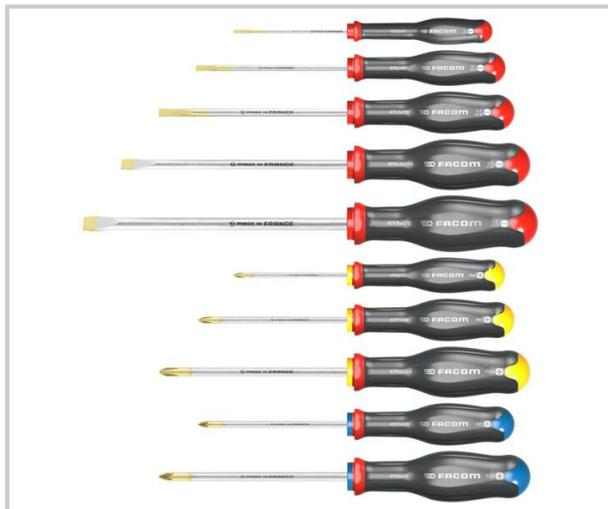
Traitement thermique en ligne : +50% de durée de vie et +100% de résistance manche Soft Grip traitement « tri-coating » de la lame (Zinc-Nickel-Chrome) marquage laser usinage des empreintes par commande numérique composition: - 5 tournevis Fente : 2.5x75mm, 4,0x100mm, 5.5x125mm, 6.5x150mm, 8,0x175mm. - 2 tournevis Pozidriv : PZ1x100mm, PZ2x125 mm - 3 tournevis Phillips : PH0x75mm, PH1x100mm, PH2x125mm.
