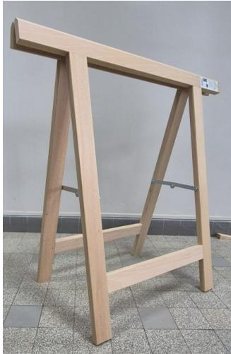
Hêtre 1er choix assemblé par tenons et mortaises, chevillé, collé compas zingués de 200 mm charnières zinguées de 50 x 30 mm hauteur ouverte : 750 mm largeur : 770 mm section des bois : 50 x 20 mm.
