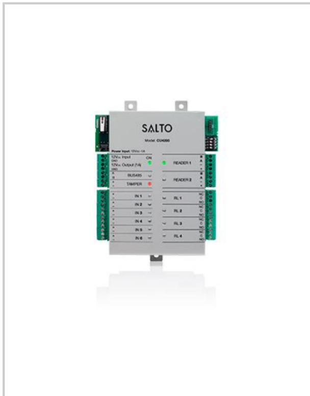
Unité de contrôle on-line si connectée via le BUS485 à l'unité CU42E0.
