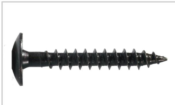
Vis bois à tête large performante et polyvalente appropriée à la pose des pentures sur volet en remplacement de boulon TRCC / Japy empreinte Torx profonde évite l'utilisation de rondelle idéale pour le chevillage cône de résistance et de centrage sous tête filetage total.
