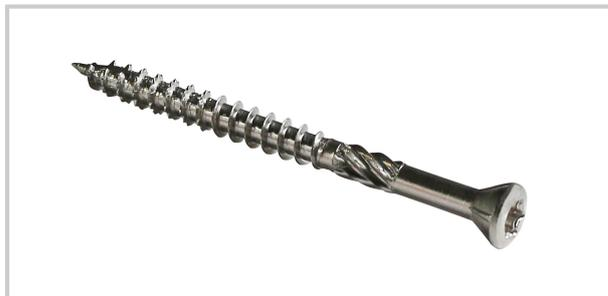
Traitement Inox A2 /A4 pour une forte résistance en extérieur, empreinte plus profonde pour une meilleure tenue de l'embout, crans sous tête pour l'auto-fraisage, moletage pour réduire l'effort de vissage, filet cranté pour une meilleure pénétration, pointe anti-fendage pour éviter l'éclatement du bois empreinte Torx.
